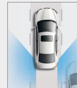
**Système d'avertissement sur l'angle mort** Si le système d'avertissement sur l'angle mort livrable détecte un autre véhicule dans l'angle mort, un témoin s'allume sur le montant de la portière du conducteur ou du passager avant, ainsi que sur l'écran d'aide à la conduite perfectionné livrable. Si vous activez alors le feu de virage, le témoin lumineux clignotera et un signal sonore retentira<sup>1,3,10,11</sup>.
