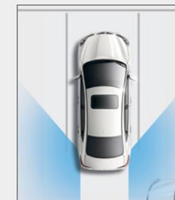
**Système d'alerte de trafic transversal** Lorsque vous sortez d'une place de stationnement en marche arrière, ce dispositif de détection livrable surveille tout autour l'arrière de votre Sentra, et peut vous avertir si des véhicules s'approchent de chaque côté, que vous ne pourriez pas voir derrière vous. Reculer est donc plus facile que jamais<sup>1,4</sup>.
