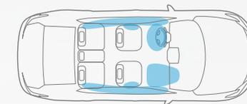
**Six coussins gonflables de série<sup>8</sup>.** Le système de coussins gonflables perfectionné de Nissan comprend des coussins gonflables avant et des capteurs de ceinture de sécurité et de classification de l'occupant<sup>9</sup>. De plus, la Maxima<sup>10</sup> est munie de coussins gonflables latéraux intégrés aux sièges avant<sup>8</sup> et de rideaux gonflables latéraux intégrés au pavillon avec capteur de capotage<sup>8</sup>.
