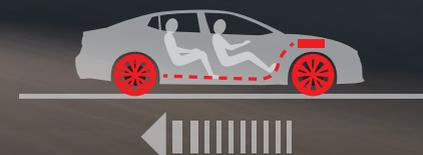
**Système de frein moteur actif.** Lorsque vous appliquez les freins, le système de frein moteur actif de la Maxima rétrograde la boîte de vitesses, ce qui permet de ralentir le véhicule avec moins d'effort tout en rehaussant le sentiment de confiance de freinage<sup>2</sup>.
