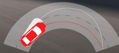
**Contrôle actif en virage.** En appliquant sélectivement les freins en virage, le contrôle actif en virage de la Maxima peut automatiquement serrer les freins intérieurs ou extérieurs afin d'aider à optimiser votre trajectoire dans les virages<sup>1,2</sup>.
